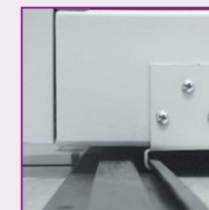
Torowisko wpuszczane w podłogę.
