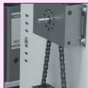
Solidny mechanizm korbowy – duże przełożenie, łatwość przesuwu.
